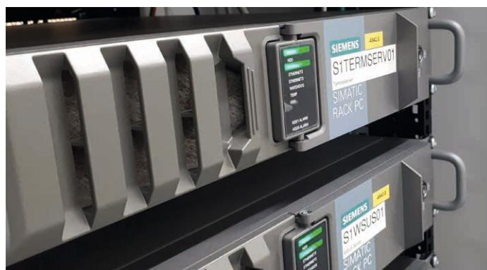
Alle Hardware- und Softwarekomponenten für die DMZ wurden sorgfältig nach den Anforderungen ausgewählt. Dabei wurden klassische DMZ-Komponenten wie Firewall, Quarantäne-PC, WSUS- und Terminalserver ebenso integriert wie spezifische Elemente für eine PCS 7 Anlage, z.B. eine SIMATIC Management Konsole sowie ein PCS 7 Webserver. Durch die Segmentierung der Netzwerke wird eine klare Trennung zwischen dem PCS 7-Netzwerk (OT) und der Unternehmens-IT gewährleistet, wobei die DMZ als Pufferzone dient.
